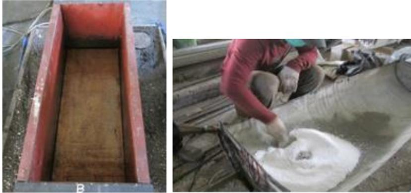
Gambar 4. Cetakan (begisting) dari plat baja dan pencampuran material
