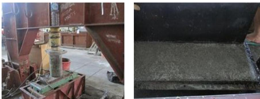
Gambar 6. Pengempaan menggunakan hydraulic jack dan pelepasan benda uji dari cetakan
