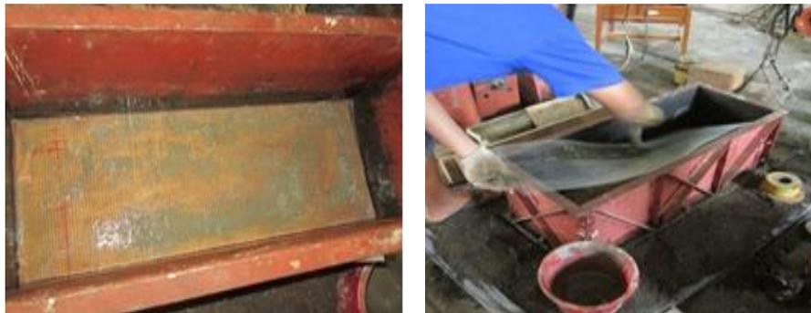
Gambar 5. Peletakan kawat loket bagian bawah dan bagian atas setelah campuran dituang ke dalam cetakan
